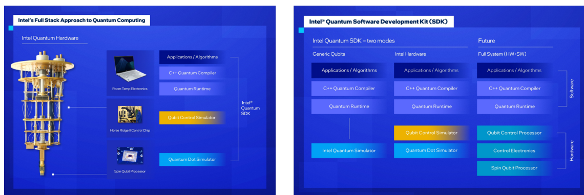
Figura 48: Soluciones HW/SW (izquierda) y estructura del Intel Intel Quantum Software Development Kit (derecha) [ https://www.intel.la ].
